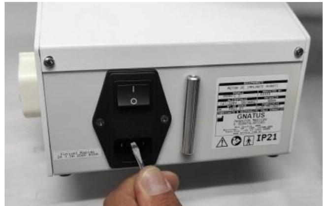
3. Retire o porta-fusível do compartimento. E substitua o fusível queimado pela mesma especificação \*.
