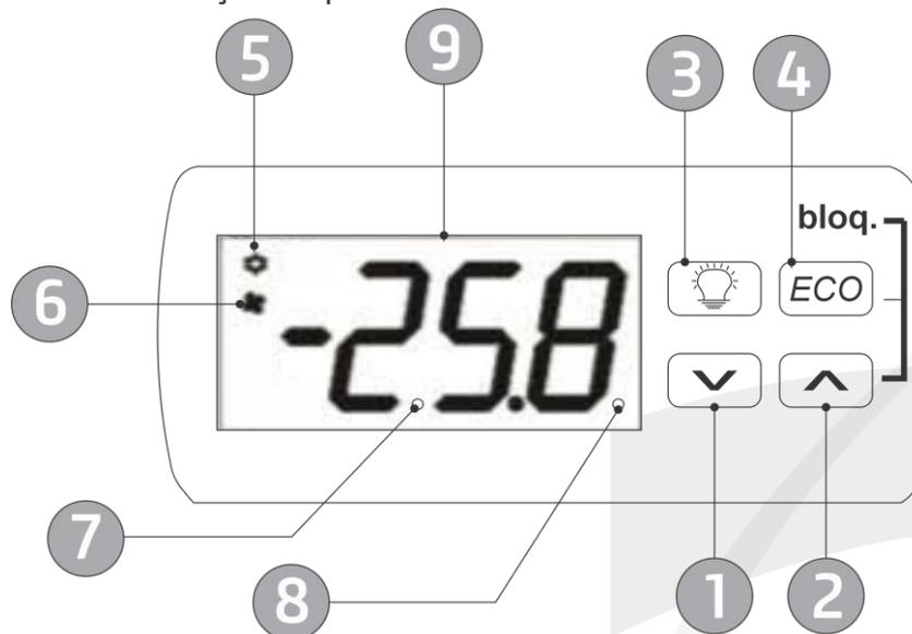
**SET POINT:** Para acessar os parâmetros de configuração mantenha pressionado por 5 segundos as Teclas Light (3) e Tecla Eco (4). **Não é recomendável executar esta função, o controlador vem configurado de fábrica. Em caso de desconfiguração dele, acionar a ASSISTÊNCIA TÉCNICA AUTORIZADA DA GNATUS.**
